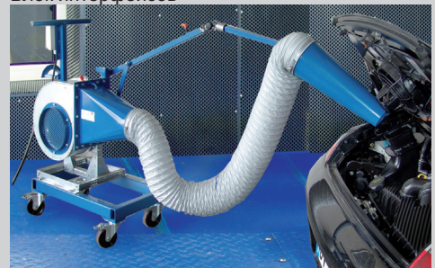
Дополнительный охлаждающий вентилятор для агрегатов автомобиля
