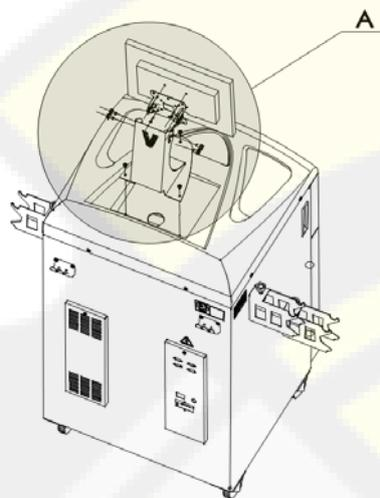
1. Демонтировать фланец с кронштейна, вывернув винты М6х16.
