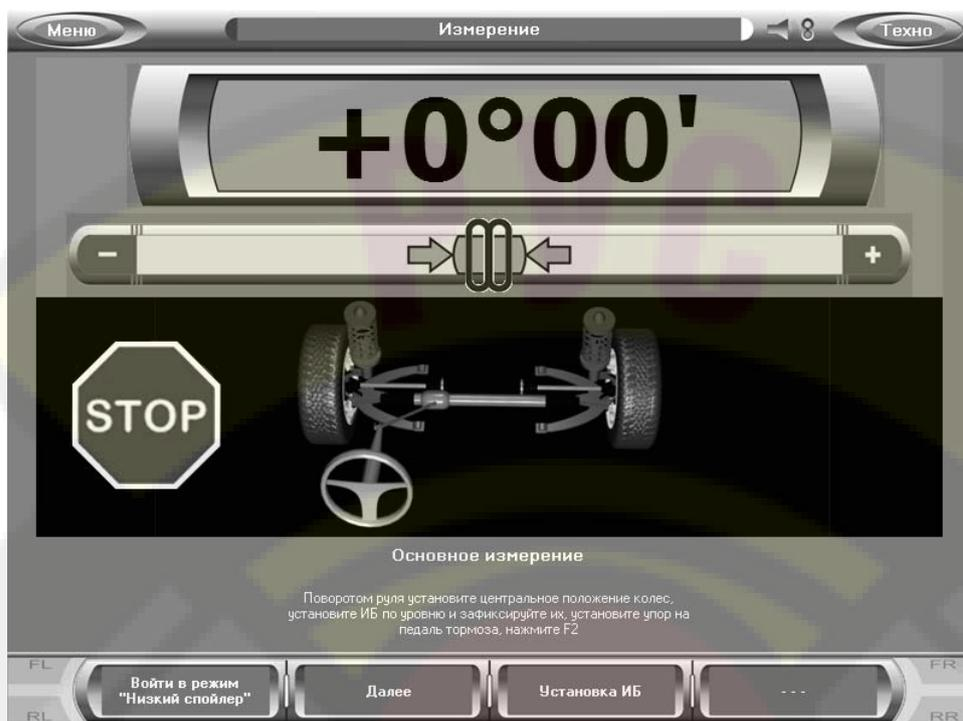
Если автомобиль имеет низкий спойлер, мешающий прямой видимости между измерительными блоками, нажмите F1 – «Войти в режим “Низкий спойлер”».
