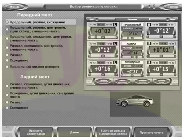
Для того, чтобы провести повторное измерение или завершить работу с клиентом, требуется обязательно выйти из режима «Вывешенные колеса».
