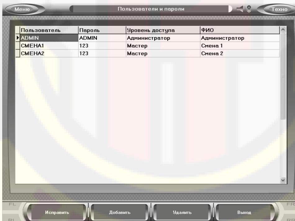
После ввода имени пользователя и пароля на экране монитора появляется режим, позволяющий: - провести настройки – «F3» или «Настройка», начать процесс измерения – «F2» или «Начало работы», получить справочную информацию – «F1»или «Помощь».
