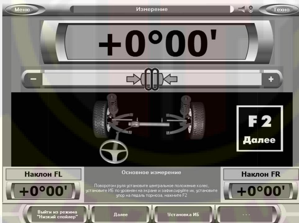
Поворачивая руль, установите передние колеса по центру, ориентируясь на зеленую зону шкалы на экране монитора. При нормальной центровке, цвет прямоугольника, на котором отображается цифра значения центровки на экране монитора меняется с красного на зеленый. Поправьте, если необходимо, угол наклона по появившимся индикаторам на экране. Дождавшись появления на экране надписи «F2 Далее», нажмите клавишу «F2» или «Далее»
