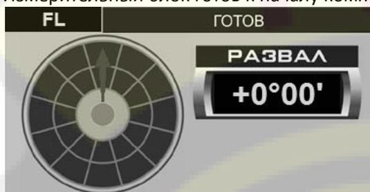
Измерительный блок находится в состоянии компенсации
