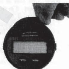
4. Верните на место крышку батарейного отсека и надежно привинтите
