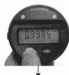
Нажмите “Total” один раз для изменения коэффициента коррекции. Изменяемая цифра мигает и может быть установлена посредством кнопки “Reset”. Для изменения следующей цифры нажмите “Total”.
