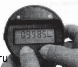
Нажмите по три раза “Total” и “Reset” для перехода в режим программирования. Единица измерения “L” (литр) мигает и может быть изменена на L (литр) GAL (галлон), QT (квата), или PT (пинта) путем нажатия “Reset”. Нажмите “Total” для подтверждения новой единицы измерения.
