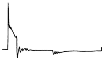
Слишком высокое сопротивление вторичной цепи
