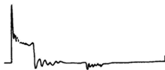
Отложения, нагар на свече зажигания
