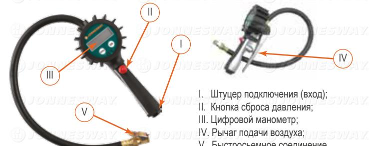
Включить прибор, нажав кнопку «ON» и настроить устройство (см. блок-схему настройки устройства). Подключить к пневматической линии через штуцер (I). Быстроъемное соединение (V) подключите к шине. Цифровой манометр (III) определит давление. Если давление вшине превышает норму, необходимо стравить его при помощи клапана сброса давления (II). Если давление вшине ниже нормы, нажать на рычаг подачи воздуха и отпустить его при достижении необходимого значения.
