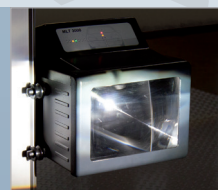
Прибор проверки фар
