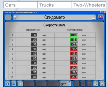
Тест спидометра Цифровое отображение действительной скорости; также может быть оценена точность одометра
