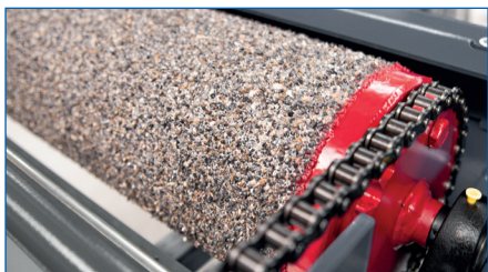
Ролики с пластиковым/ каменным покрытием
