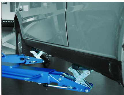
MINI-MAX: удобный подхват под низкие пороги
