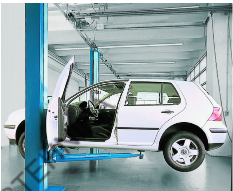
Ассиметричная конструкция позволяет свободно открывать двери
