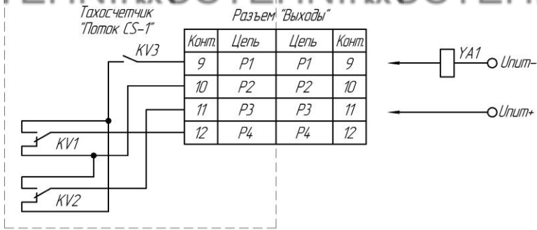
Рисунок 4.2 - Управление шторкой. Схема 2 "Электромагнит"
