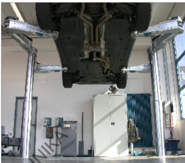
2.50 TTK с двухшарнирными захватами
