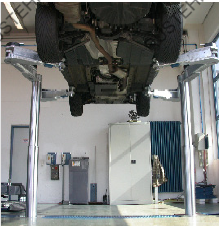
2.50 TTKAS с двухшарнирными захватами, грузоподъемность 5 т
