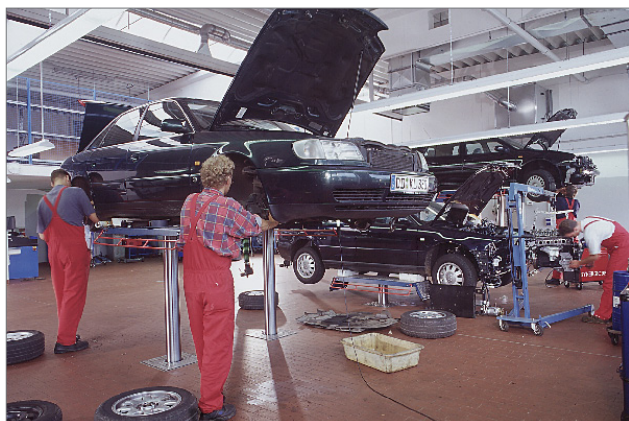
Шинный сервис и кузовной ремонт - оптимальный доступ к кузову и колесам благодаря коротким платформам
