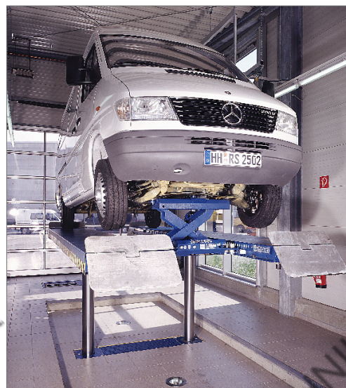
2.50 ТТА с длинными платформами и осеподъемником
