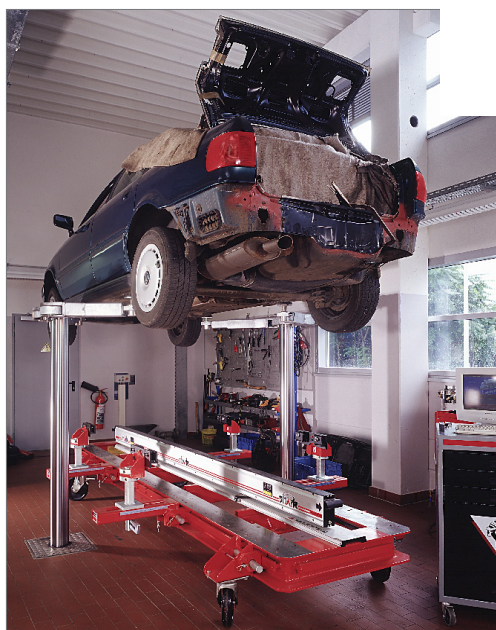
2.35 TSK STANDARD · идеально подходит для работы на кузовном стапеле, благодаря большому расстоянию между плунжерами.
