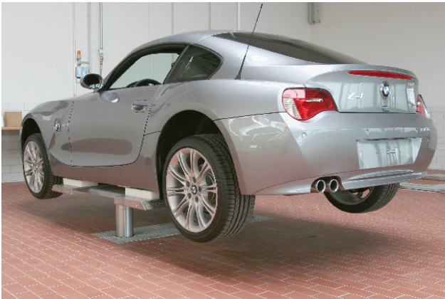
2.35 TS с универсальными платформами для DC-BMW
