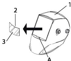
Die Außenscheibe (2) ist durch Druck auf den Punkt (A) des Helmes (1) unter der Scheibe entfernbare.
