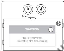
Для смены внутреннего защитного экрана (10), передвиньте его вниз нажимая пальцем на точку (A). Во время замены экрана не забудьте снять заранее защитную пленку (11)
