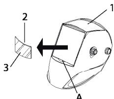
La pantalla protectora exterior (2) se puede extraer poniendo un dedo sobre la pantalla en el punto (A) de la máscara (1).
