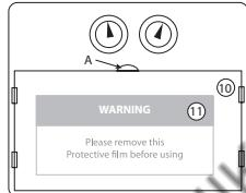
Para cambiar la pantalla de protección interior (10), deslícela hacia abajo colocando un dedo en el punto (A.). Cuando realice el cambio, recuerde retirar antes el film protector (11).
