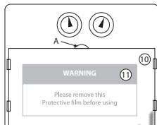
Zum Ersetzen der Innenscheibe (10), lösen Sie diese durch Druck auf Punkt (A). Beim Ersetzen einer Scheibe vorher die Folie (11) entfernen.
