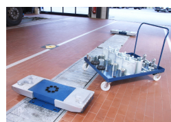
Для подхвата автомобиля существуют различные адаптеры
