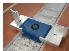
Для подхвата автомобиля существуют различные адаптеры
