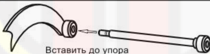
Рисунок 7.6 – Использование удлинителя линейки
