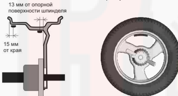
Рисунок 6.7 – Установка ленточных грузов
