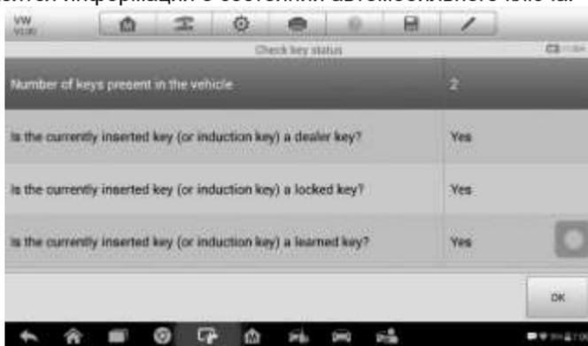
**Рисунок 4-6. Пример окна, содержащего результаты проверки состояния ключа**
