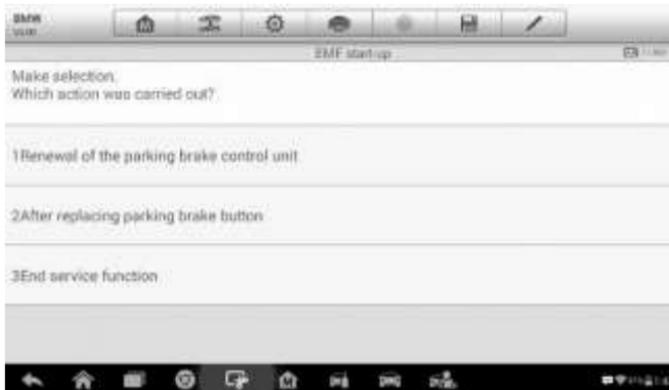
Рисунок 7-7. Пример второго окна включения электромеханического стояночного тормоза
