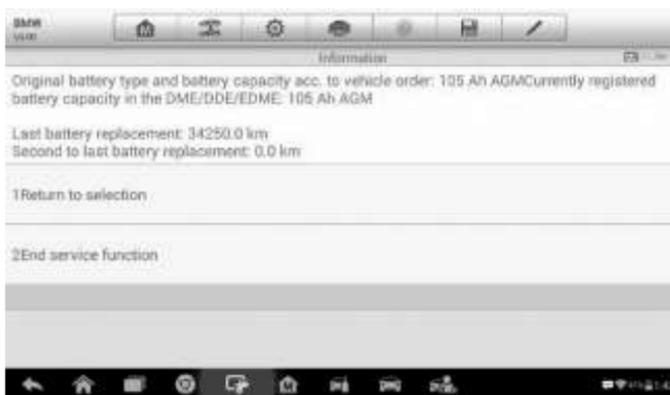
**Рисунок 7-12. Пример третьего окна настройки системы управления аккумулятором**
