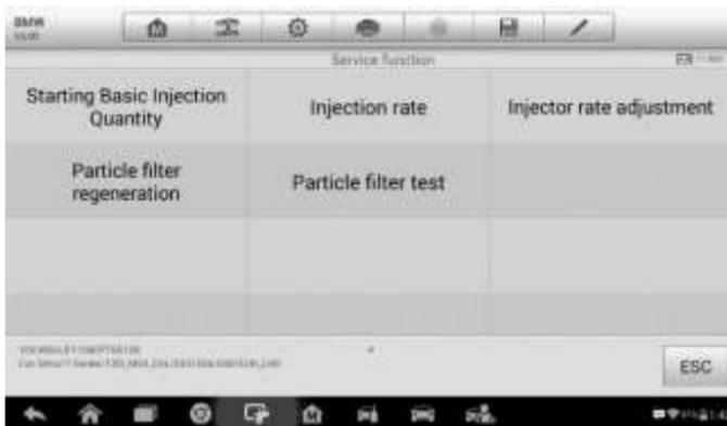
Рисунок 7-21. Пример меню функций техобслуживания сажевого фильтра
