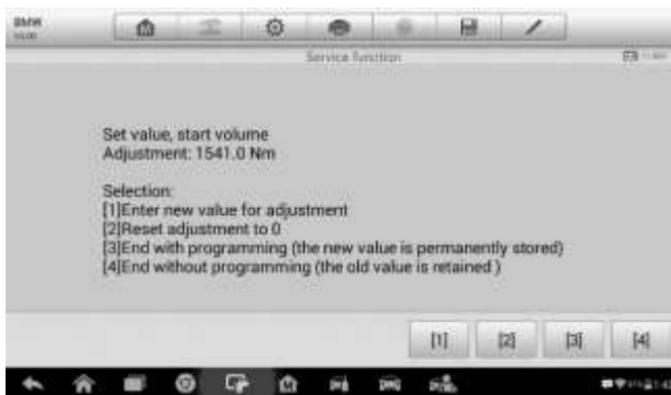
Рисунок 7-22. Пример окна функций базового объёма проверки
