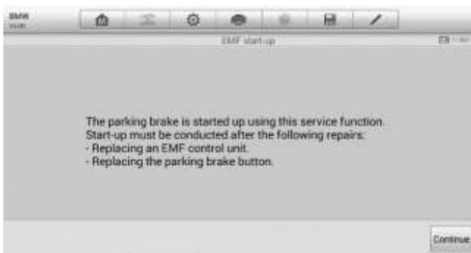
**Рисунок 7-6. Пример экрана включения электромеханического стояночного тормоза**
