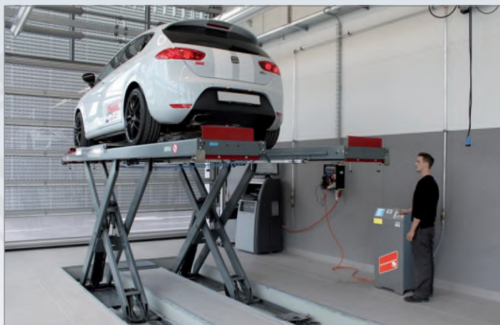
Полезная высота мин. 1850 мм при монтаже в ленточный фундамент.
