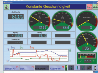
Моделирование реальных дорожных условий, включая временные графики..
