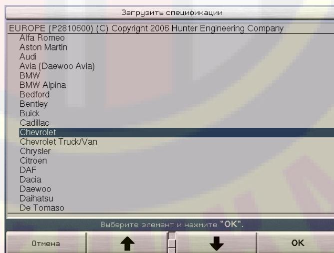
Опять же с помощью клавиши или переместите курсор на год выпуска и модель регулируемого автомобиля; пролистывать страницы этого списка можно клавишей или . Некоторые автомобили имеют мульти подменю.
