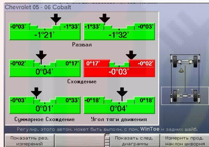
Когда регулировочные значения задних колес будут приведены в норму, переходите к регулировке развала и продольного наклона поворотного шкворня передних колес. Нажмайте клавишу «Показать след. диаграммы» до тех пор, пока нужные диаграммы не появятся на экране.
