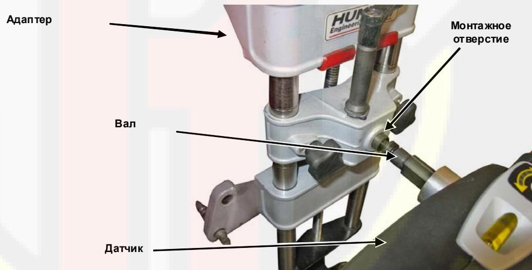
Прижав тесно датчик или мишень к колесному адаптеру, зафиксируйте вал с помощью стопорной рукоятки. Обращайтесь к следующему разделу для информации по стопорной рукоятке.
