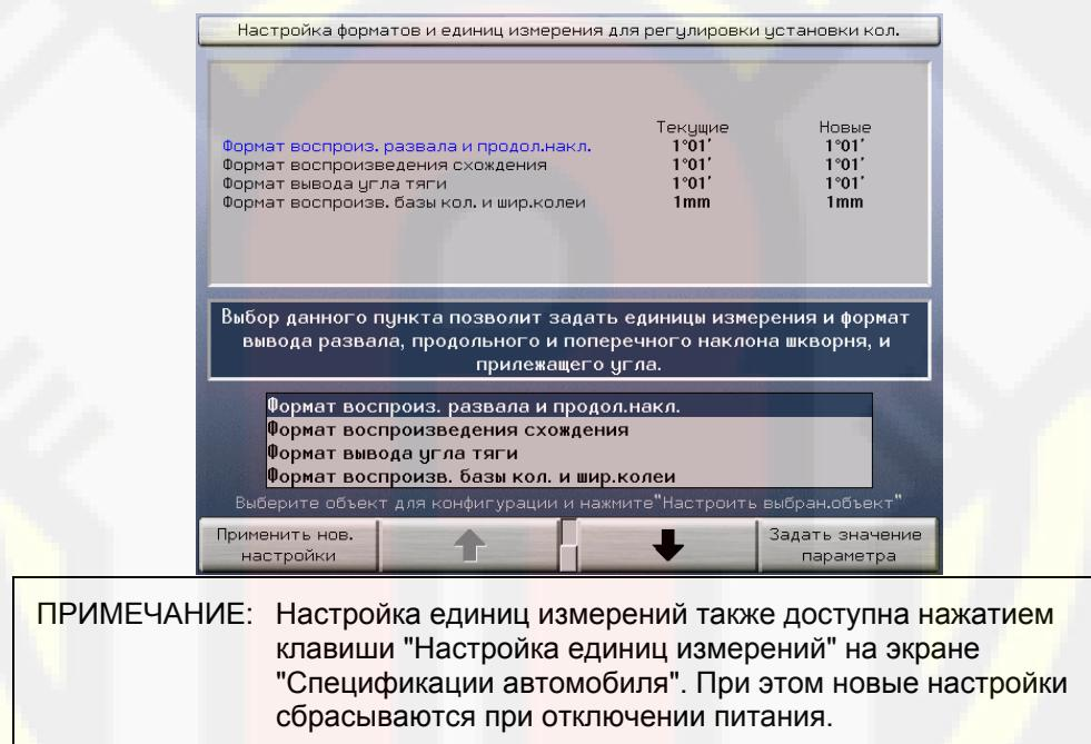
**ПРИМЕЧАНИЕ:** Настройка единиц измерений также доступна нажатием клавиши "Настройка единиц измерений" на экране "Спецификации автомобиля". При этом новые настройки сбрасываются при отключении питания.
