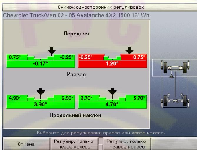
Его вызов осуществляется нажатием клавиши «Регулировать только одно колесо» на экране «Регулировка передними шайбами» или «Регулировка передними эксцентриками и пазами».
