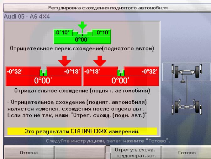
Если значения не в пределах спецификаций (отрицательные или положительные), отрегулируйте схождение к спецификации повторяя процедуры «Отрегулировать схождение поднятого автомобиля».
