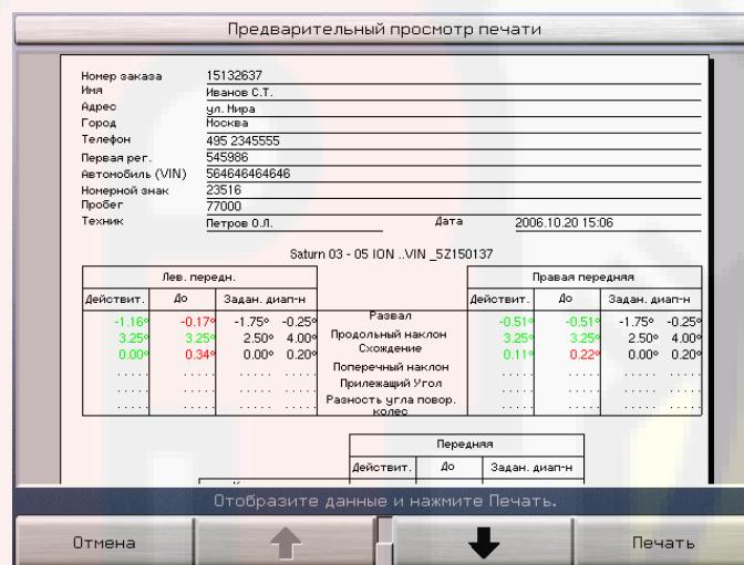
Нажмите «Печать» для распечатки отчета. Экран перейдет на «Измерения и регулировки автомобиля». Снимите датчики и сбросьте программу.
