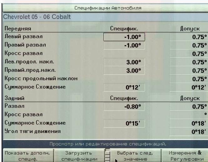
Спецификации можно загрузить на любом этапе процесса регулировки. Загруженные спецификации заменят все спецификации, отображаемые в данный момент на экране «Спецификации автомобиля».
