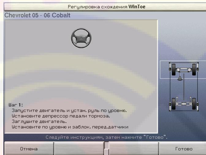
Этот экран вызывается нажатием клавиши «Регулировка схождения WinToe» на экране «Измерения и регулировки автомобиля».
