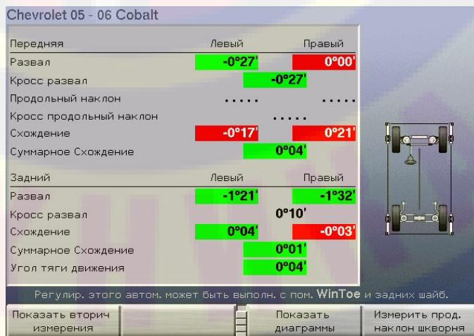
На дисплее появится экран измерения продольного и поперечного наклона поворотного шкворня. Следуйте инструкциям на экране и поворачивайте колеса в соответствии с указаниями. После окончания измерения продольного наклона поворотного шкворня на дисплее снова появится экран «Измерения и регулировки автомобиля».
