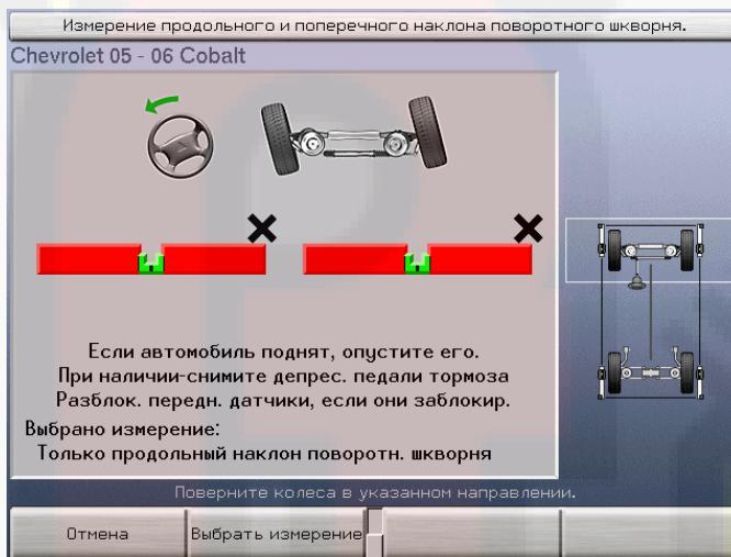
Вызов этого экрана осуществляется нажатием клавиши «Измерить кастер» на экране «Измерения и регулировки автомобиля».
