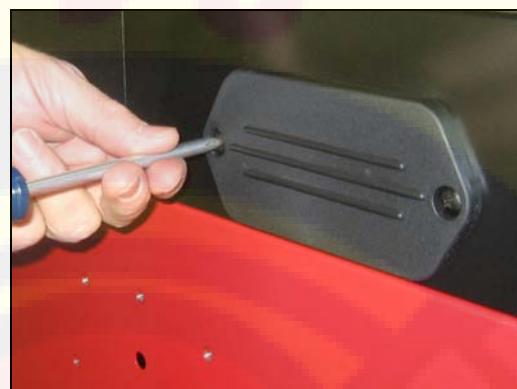
Снимите крышку программного картриджа.
