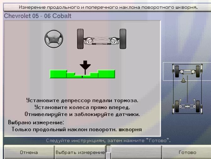
Установите депрессор педали тормоза. Вращая рулевое колесо, поставьте колеса прямо – так, чтобы диаграмма показывала «центральное» положение. Затем отнивелируйте и зафиксируйте датчики. Нажмите клавишу «Готово» – это позволит системе сделать «снимок» текущих измерений.
