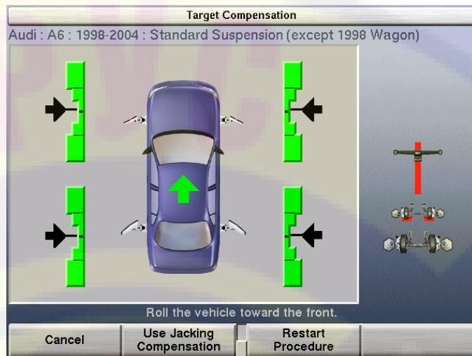
После окончания компенсации всех четырех мишеней поставьте автомобиль на стояночный тормоз и переведите рычаг переключения передач в положение "парковка". На автомобилях со стандартной трансмиссией рычаг переключения передач следует установить на нейтраль.
