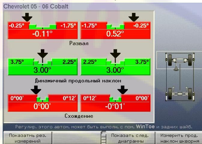
Когда используется формат «регулировки в ноль», под диаграммой в цифровом виде отображается разница между фактическим результатом измерений и спецификацией. Числа на каждом конце диаграммы являются пределами допуска
