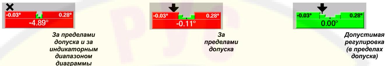
Серый цвет диаграммы указывает на то, что либо для этого угла не введена спецификация или допуск, либо возникли препятствующие измерению проблемы с датчиком, например: датчик не подключен, не скомпенсирован, либо блокирован луч схождения.
