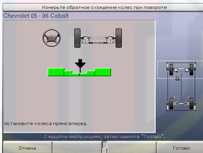
При повороте руля «внутреннее» колесо поворачивается больше, чем «внешнее». Благодаря этой схеме все четыре колеса получают возможность повернуться практически на одной точке, что позволяет избежать протирания и излишнего износа шин. «Разница углов поворота» -- это величина разницы между углами поворота колес при повороте одного из них на поворотный «базовый» угол. «Левая» разница углов поворота измеряется, когда колеса повернуты влево, а «правая» – когда колеса повернуты вправо.
