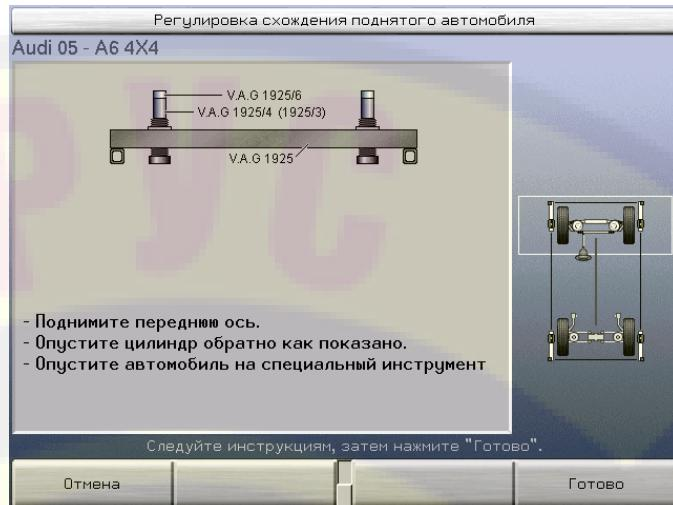
Нажмите Готово и экран покажет дополнительный спец. инструмент и инструкции. Нажмите Готово для выведения экрана «Регулировка схождения поднятого автомобиля». Это не активный экран, о чём известит Вас желтое предупреждение.
