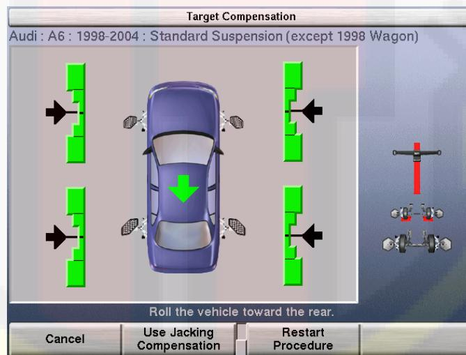
**ПРИМЕЧАНИЕ:** Автомобиль с диаметром шин 28 дюймов сантиметров нужно прокатить примерно на 30-35 см. Чем больше диаметр шин, тем дальше нужно прокатить автомобиль, и наоборот.
