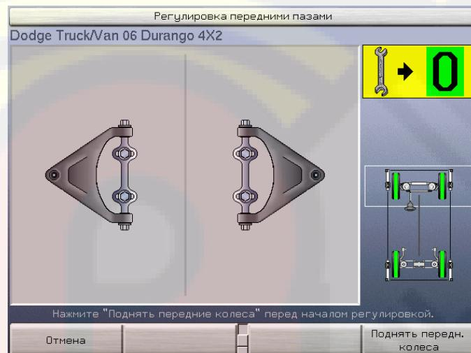
Регулировку следует проводить при поднятой передней оси. Для этого предусмотрена функциональная клавиша с ярлыком «Поднять передние колеса». Нажмите эту клавишу и следуйте инструкциям по подъему передних колес как описано в разделе «Регулировка с поднятыми осями».
