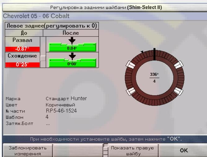
Этот экран вызывается нажатием клавиши «Регулировка задними шайбами» на экране «Измерения и регулировки автомобиля». Эта функциональная клавиша появляется только в том случае, если база данных спецификаций определяет, что на данном автомобиле можно произвести такую регулировку.
