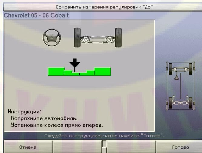
Когда результаты измерений стабилизируются, программа сохранит их и на дисплее снова появится экран «Измерения и регулировки автомобиля».
