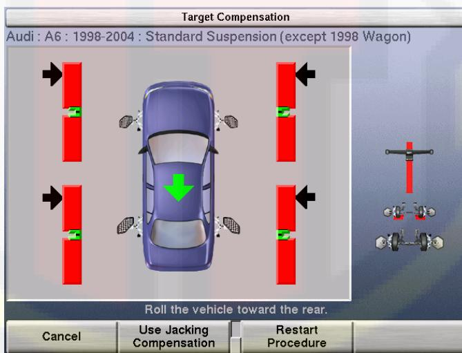
Убедитесь в том, что стопорные штифты установлены в поворотные круги и задние сдвижные панели. Разместите мостики поворотных кругов в каждом кармане за кругом так, чтобы поверхность качения стала ровной. Поверните мосты так, чтобы в высоту они стали больше, чем в ширину.
