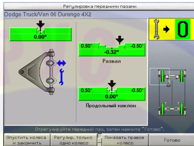
В случае необходимости продолжите регулировку и доведите ее до максимальной точности, переключаясь между фронтальным и тыловым пазом нажатием клавиши «Готово». Каждый раз при нажатии клавиши «Готово» алайнер, прежде чем переключиться на другой паз и показать его диаграмму, повторно анализирует необходимые изменения.
