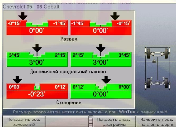
В начале регулировки кастера поставьте колеса прямо вперед и зафиксируйте рулевое колесо. После этого датчики начнут отслеживать изменения кастера по мере того, как Вы будете осуществлять регулировку. Следя за диаграммами, отрегулируйте по ним развал и кастер передних колес.
