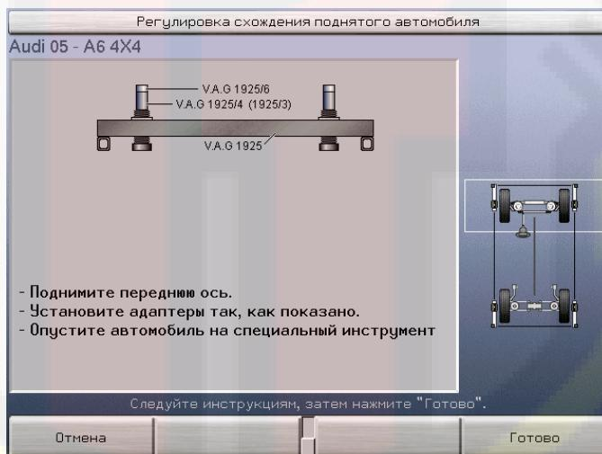
Нажмите Готово и появиться следующий экран Экран покажет иллюстрацию должного места регулировки и две диаграммы регулировки (левую и правую). Следуйте инструкциям.
