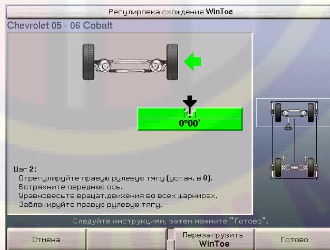
Следуя инструкциям на экране, отрегулируйте правую поперечную рулевую тягу так, чтобы индикатор на диаграмме оказался в центральном положении.
