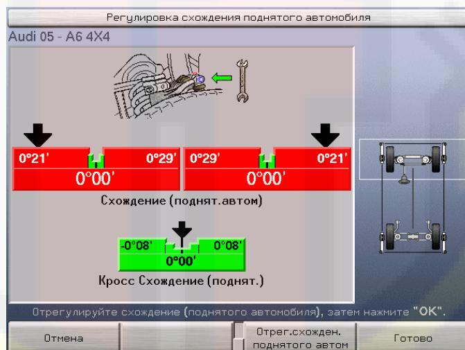
Отрегулируйте схождение к спецификации и нажмите «Готово». Следующий экран отобразит дополнительные инструкции.
