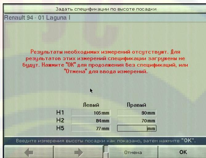
**⚠ ВНИМАНИЕ:** Если не измерить обе стороны автомобиля либо если он неровно нагружен или имеет «просаженные» пружины, результаты измерений могут оказаться неверными.
