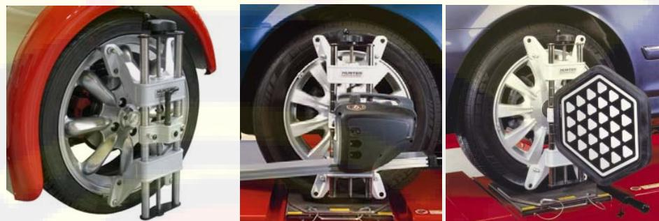
**⚠ ВНИМАНИЕ:** Затяжку фиксирующих ручек центрального шквона следует производить с максимально возможным ручным усилием (НЕЛЬЗЯ ИСПОЛЬЗОВАТЬ ИНСТРУМЕНТЫ ДЛЯ ЗАТЯЖКИ).
