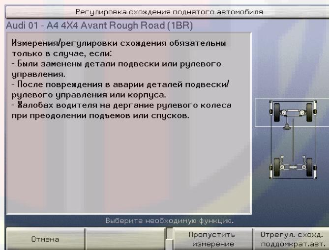
Выбор «Регулировать схождение поднятого автомобиля» выведет следующие экраны данной процедуры с показом спец.инструмента VAG и инструкций. В зависимости от спецификаций автомобиля спец. инструмент разнится. Следуйте инструкциям на экране.
