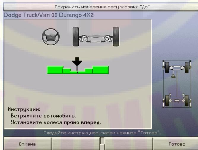
Он вызывается нажатием клавиши «Сохранить измерения» на экране «Измерения и регулировки автомобиля».
