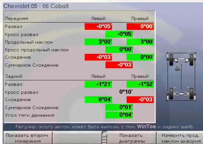
Вызов этого экрана осуществляется нажатием клавиши «Измерения и регулировки автомобиля».
