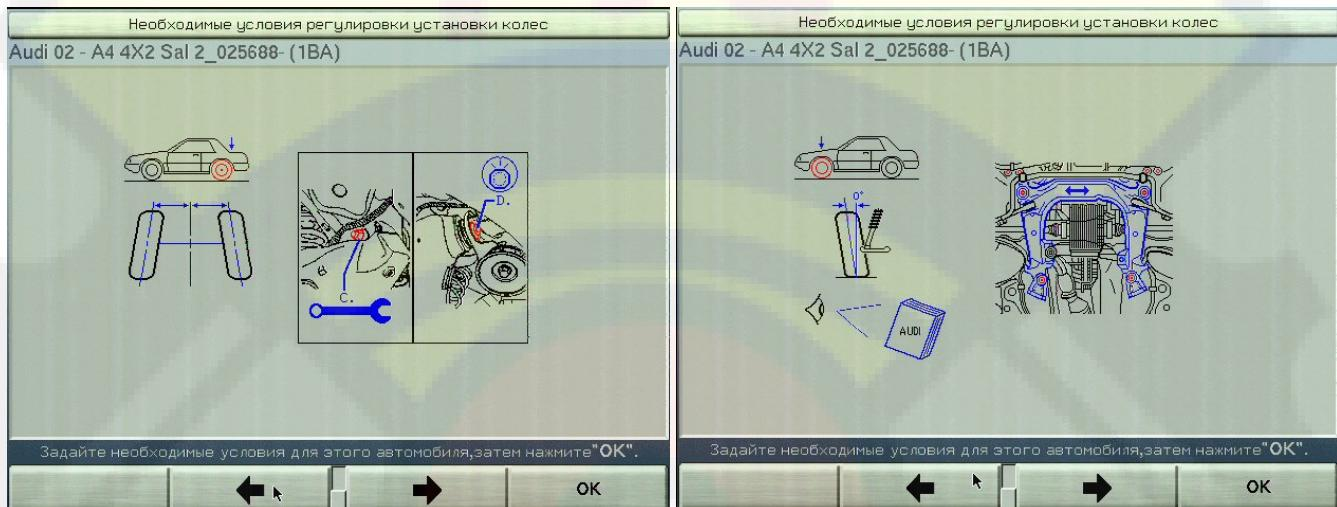
Он появляется автоматически после загрузки спецификаций автомобиля, если для данного автомобиля в базе имеются подобные иллюстрации. Кроме того, его можно вызвать нажатием клавиши «Проиллюстрировать регулировки» на экране «Спецификации автомобиля» или «Измерения и регулировки автомобиля».
