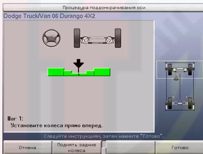
Он вызывается нажатием клавиши «Подъем или опускание оси» на экране «Измерения и регулировки автомобиля» или на экране «Регулировка передними эксцентриками и пазами» в начале регулировочной процедуры.
