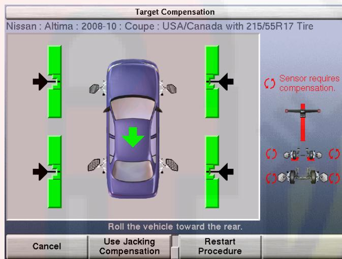
Установите на колеса датчики и скомпенсируйте их на биение. Описание этой операции см. в разделе «Установка и компенсация датчиков».
