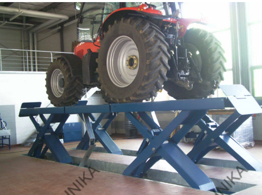
Модули подъемника могут управляться по отдельности.
