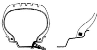
Шины камерного типа. Так как шина должна обладать способностью удерживать сжатый воздух в течение довольно продолжительного периода времени, внутри шины используется камера. В этом случае клапан, используемый для накачивания, проверки и докачки воздуха, является частью конструкции камеры.
