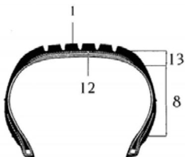
Радиальный каркас шины обладает относительно небольшой стабильностью, для повышения устойчивости и предотвращения случайных движений протектора, на каркасе и под протектором применяется кольцевая усиливающая конструкция, известная как цепь. Протектор и боковина обладают разной жёсткостью и работают отдельно, так что движения боковин не передаются протектору.
