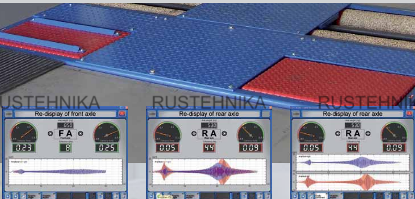
Цифровое и графическое представление измеряемых величин программным обеспечением EUROSYSTEM
