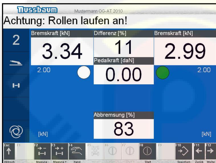
Тормозите медленно при помощи ручного тормоза, пока Вы не достигнете максимальной силы торможения при помощи ручного тормоза или пока не сработает отключение при буксовании.
