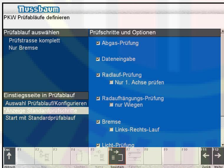
При нажатии на **F12** Вы вернетесь к стартовой заставке. Выберите в зависимости от транспортного средства **F2** для легкового транспортного средства, **F3** для грузового транспортного средства или **F4** для мотоцикла для того, чтобы начать проверку.
