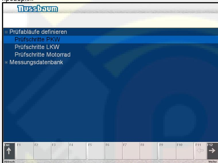
Дважды щелкните по **Prüfablauf definieren (определить ход проверки)** и выберите **LKW (грузовой автомобиль)**, **PKW (легковой автомобиль)** или **Motorrad (мотоцикл)**. Подтвердите свой выбор при помощи кнопки **F12**.
