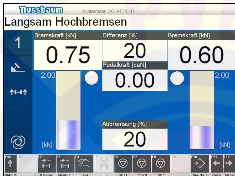
Данный этап проверки позволяет выполнить оценку состояния тормозного диска или барабана, а именно их овальность и износ.
