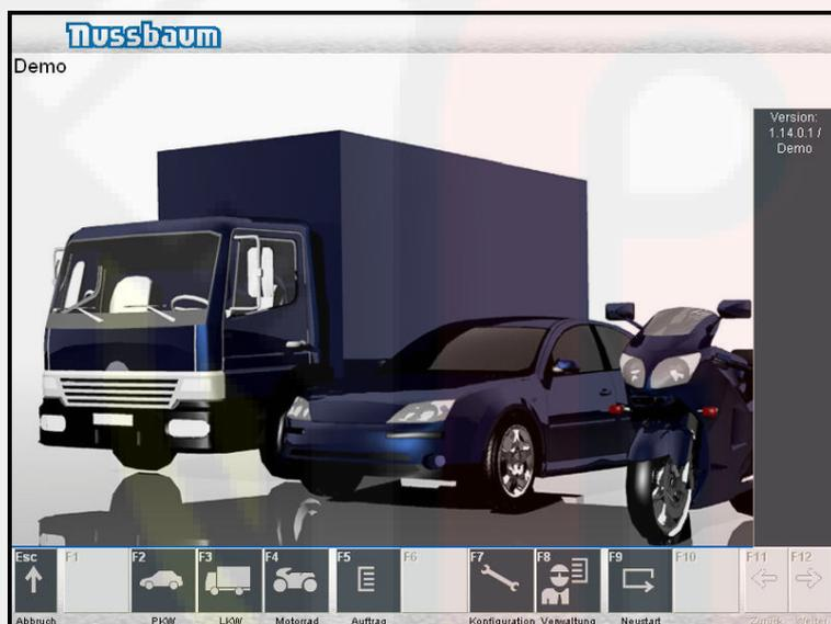
При помощи клавиши **F7** Вы можете запросить меню **Konfiguration (конфигурация)** и при помощи клавиши **F8** меню **Verwaltung (управление)**. В данных меню Вы можете менять заданные значения для испытательной линии (смотрите следующие главы)
