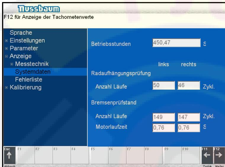
В данном окне приводится общая информация о компонентах испытательной линии, полученная при помощи измерительной техники. Во время работы измерительная техника определяет число циклов измерения на компонент испытательной линии, время работы двигателя испытательного стенда для проверки тормозной системы и время работы.
