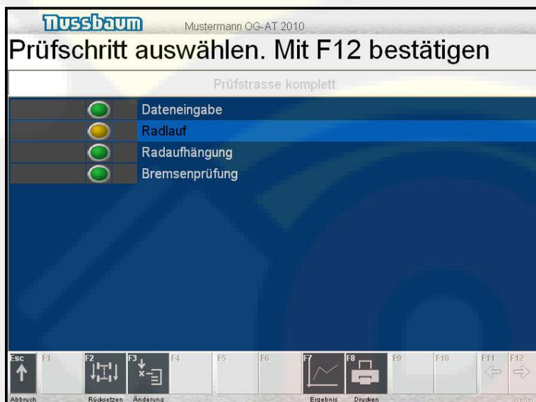
После нажатия на кнопку **F7 (результат)** в информационном окне „Prüfschrittübersicht“ (обзор этапов проверки) появится таблица с результатами в виде цифр. Данная таблица включает все значения измерения.
