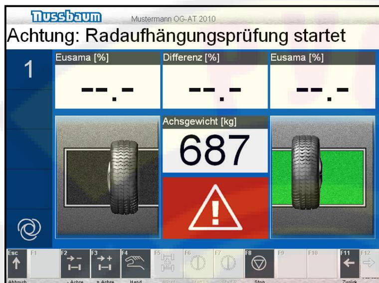
Платформа начинает колебаться для того, чтобы определить коэффициент сцепления с опорной поверхностью при помощи частоты. Для этого необходимо задать двигателю предельную частоту, после чего отключить его и выполнить измерения в движении по инерции. На дисплей будет выведено минимальное значение сцепления с опорной поверхностью.
