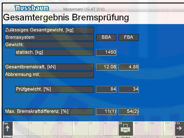
i После нажатия кнопки **F1** на дисплее снова появиться окно „Prüfschrittübersicht“ (обзор этапов проверки).
