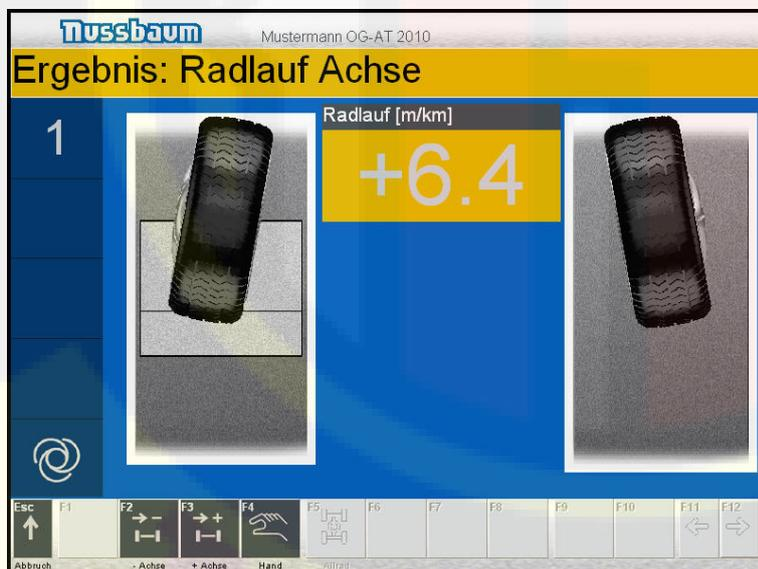
Передняя корректирующая пластина устраняет мешающие поперечные усилия (натяг) в покрышке. Следующая пластина измеряет отклонение хода колеса.
