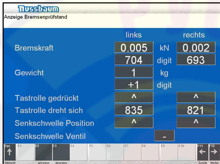
В ненагруженном состоянии значения силу торможения должны равняться 0.
