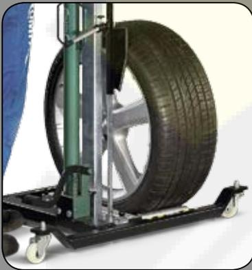
Облегченный подъем колес. Колесный подъемник поднимает колеса прямо с пола.
