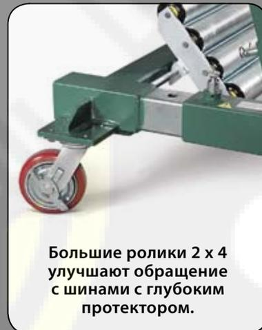
Большие ролики 2 x 4 улучшают обращение с шинами с глубоким протектором.
