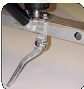
быстрой фиксации поддерживающего ролика.
