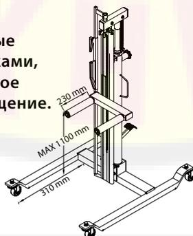
Обеспечивает легкий доступ к колесным болтам. Колесо размещается на удалении от главного плунжера.
