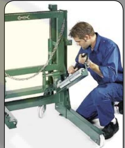
Раздвижные опоры. Позволяют обслуживать колеса диаметром 545 - 1278 мм.
