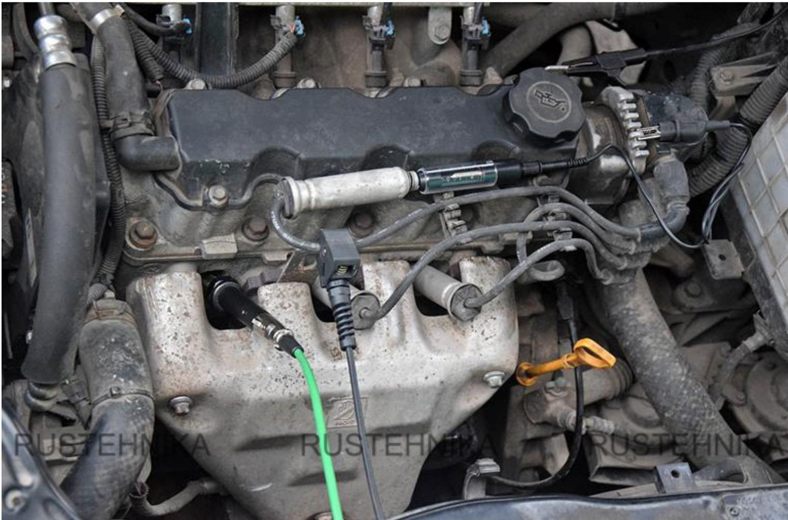
Скрипт Рх при помощи датчика давления, вкрученного на место свечи зажигания, позволяет проверить характеристики цилиндра, впускного и выпускного трактов, системы регулирования угла опережения зажигания и оценить взаимное влияние этих систем друг на друга.
