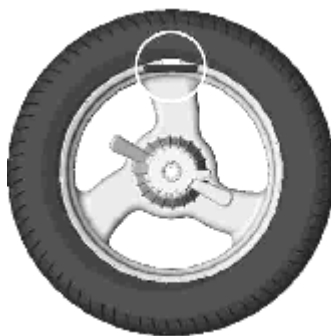
Рисунок 6.24 – Груз установлен в положение «12 часов»
