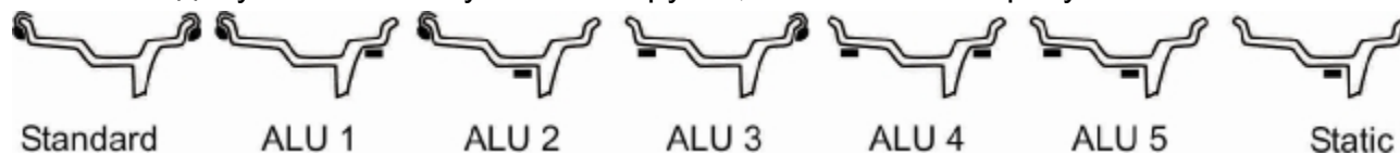
Рисунок 6.9 – Схемы установки грузов
