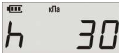
Рисунок 2.5. Максимальное значение разряжения.
