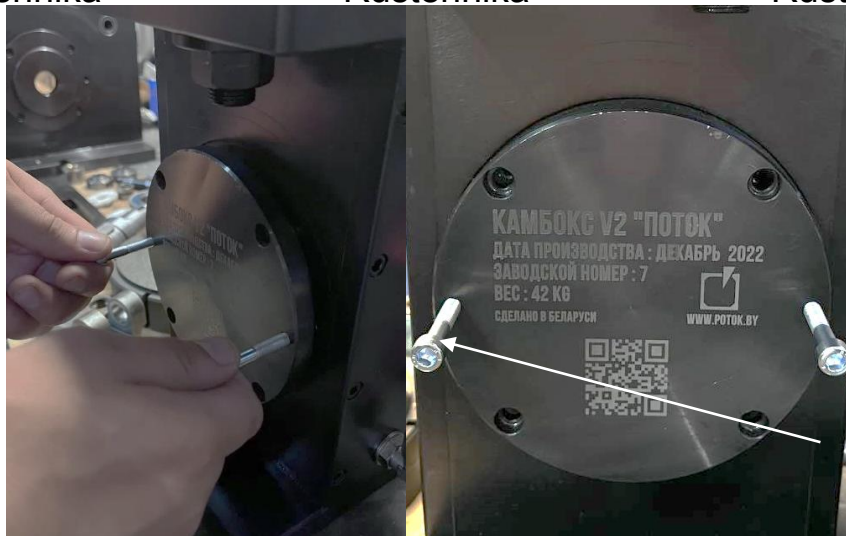
Рисунок 3.5 – Снятие крышки подшипника
