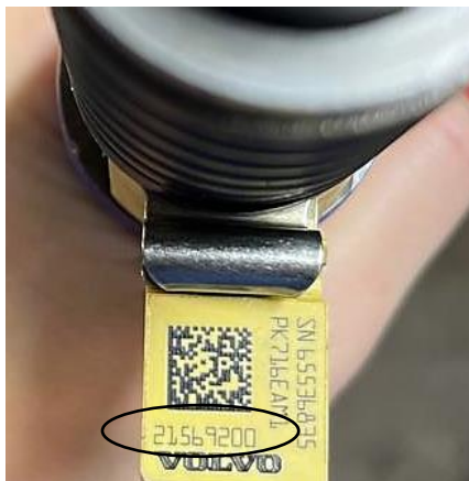
Рисунок 3.1 - Номер форсунки Bosch на электромагните
