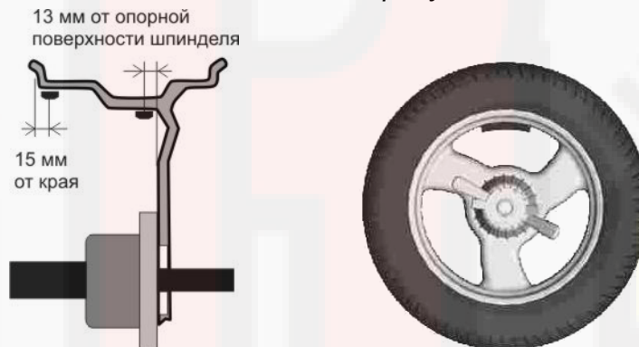
Рисунок 6.7 – Установка ленточных грузов
