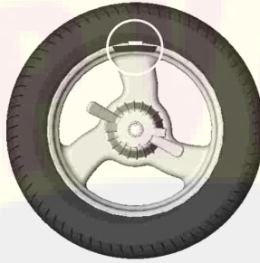
Рисунок 6.3 – Груз установлен в положение «12 часов»
