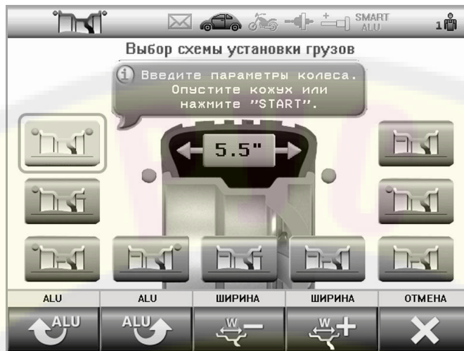
Рисунок 5.3 – Выбор схемы установки грузов
