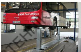
OMNI LIFT с осевой нагрузкой до 15т · Плу́нжерный подъемник, включающий от 1 до 10 подъемных колонн · 100% защита от скручивания благодаря квадратному профилю · Телескопические плунжера с глубиной установки 1.550 мм · Опционально колонны могут перемещаться электроприводом для выбора подходящей колесной базы · SST обеспечивает синхронизацию всех колонн с точностью до миллиметра.
