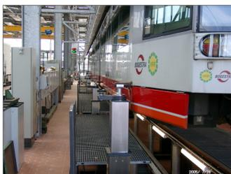
Tramway lift · Подъемник для трамваев состоит из 4 подъемных систем, каждая из которых включает 12 плунжеров грузоподъемностью 7.500 кг · Длина системы 28 м · Подъемник может поднимать трамваи на 1400 мм · Каждый плунжер настраивается по оси x и y, и имеет собственный силовой модуль. Все плунжера соединены в сеть посредством CAN-шины · SST гарантирует точную синхронизацию и одинаковый уровень всех колонн на любой высоте в любой момент времени.
