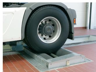
Люфт-детектор SPID 20000 с нагрузкой на колесо 10т · Предназначен для проведения визуального осмотра элементов подвески. Люфт-детектор позволяет легко выявить детали с повышенным износом. Продольное и поперечное перемещение любой стороны люфт-детектора дает возможность продиагностировать даже состояние задней оси при задействовании тормозов.
