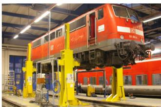
Гидравлическая подъемная система 1250 НВ · Для подъема рельсовой техники · Разработан и одобрен для немецкой железной дороги Deutsche Bahn AG · Фиксированное или мобильное исполнение · Система состоит минимум из 4 подъемных модулей, каждый грузоподъемностью 25т · SST гарантирует точную синхронизацию и одинаковый уровень всей системы на любой высоте в любой момент времени
