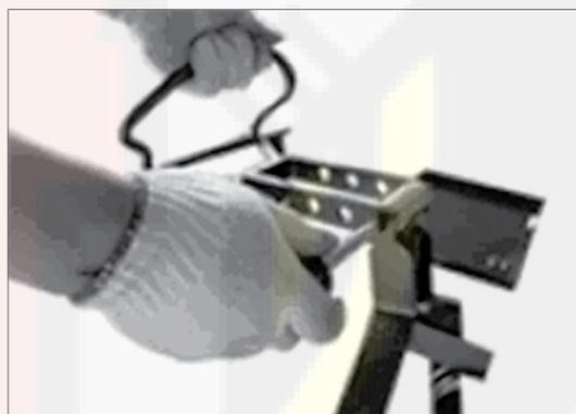
4. Нажимая педаль подъема, растяните борта шины на желаемую ширину. Если шина в процессе растяжения поднялась так высоко, что готова оторваться от устройства, то это говорит о том, что захват установлен слишком высоко и его необходимо установить на меньшую высоту, чтобы обеспечить нормальную работу.
