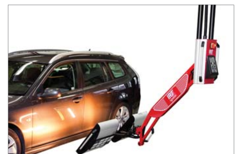
Можно выставить софиты для сушки порогов автомобилей.
