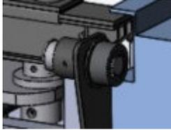
Стандартная комплектация – регулируемые по ширине ролики на каретках навесных подъемников. Регулировка каретки по ширине направляющих от 0 до + 100мм. Используются игольчатые подшипники.
