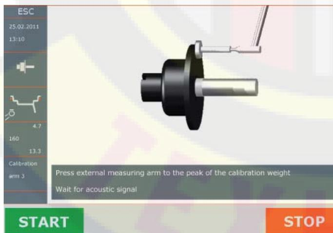
Приложите внешнюю измерительную линейку к внешнему кончику калибровочного грузика, как показано на экране и дождитесь звукового сигнала.
