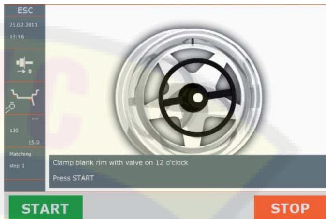
Шина должна быть снята с обода, а затем диск зажат на станке с клапаном, расположенным в положении "12 часов".
