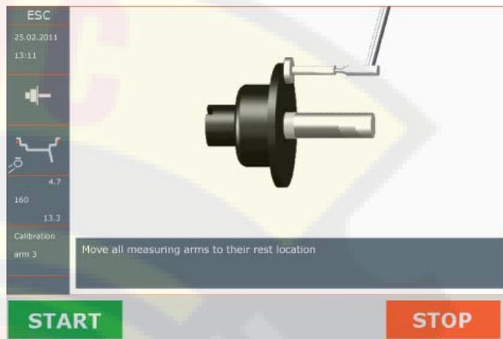
Верните обе линейки на место и дождитесь звукового сигнала.
