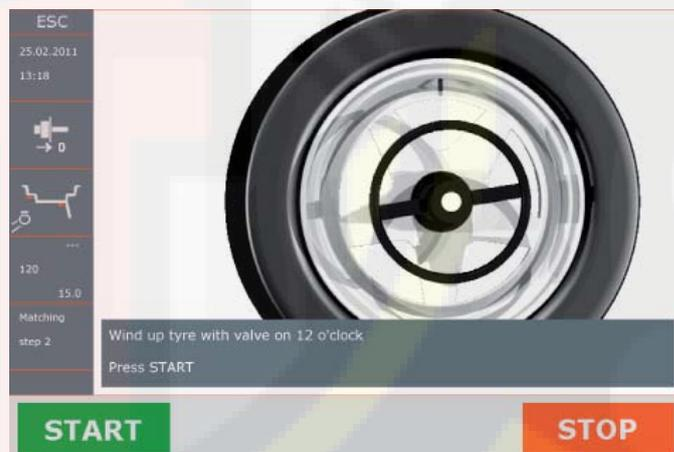
Снимите диск со станка, оденьте покрышку на диск и оденьте колесо на станок.
