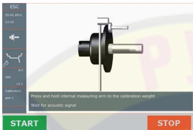
Приложите измерительную линейку к внутреннему фланцу калибровочного грузика, как показано на экране и дождитесь звукового сигнала.
