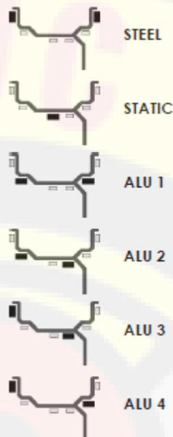
Для того чтобы измерить данные колеса, поставьте внутреннюю измерительную линейку в первое желаемое положение установки грузиков из тех, что указаны на экране «Программа балансировки». Дождитесь звукового сигнала. Для программ ALU: поместите внутреннюю измерительную линейку (10) во второе положение и дождитесь звукового сигнала. Верните линейку в первоначальное положение, и дождитесь звукового сигнала.
