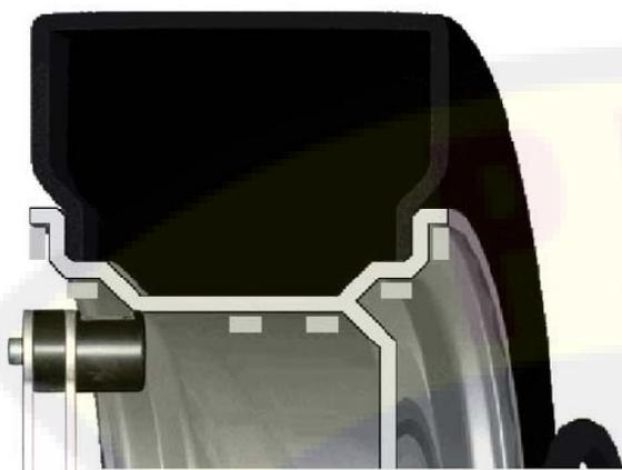
Линейка в положении измерения программы алюминиевых дисков для грузиков на клею (показано для левого)
