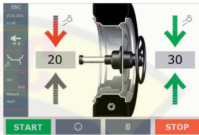
Установите клеящийся грузик на головку измерительной линейки и снимите защитную пленку. Стальные клеящиеся грузики держаться на головке при помощи магнита. Сместите измерительную линейку с ее исходного положения.
