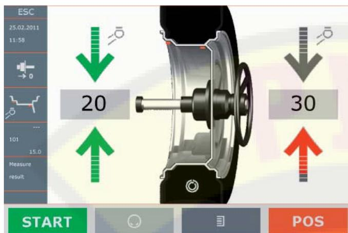
Установите клеящийся грузик на головку измерительной линейки и снимите защитную пленку. Стальные закрепляющие грузики держаться на головке при помощи магнита.
