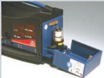
Новый тип основного фильтрующего устройства с активным водоотделителем, конденсат удаляется автоматически
