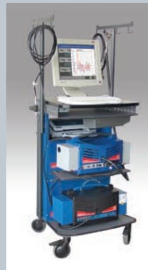
Газоаналитическая стойка (вместе с газоанализатором MGT 5)
