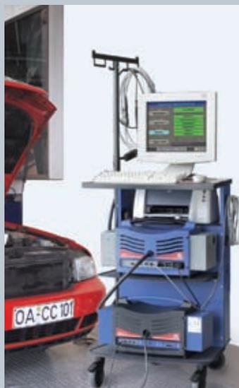
Измерение дымности легкового автомобиля
