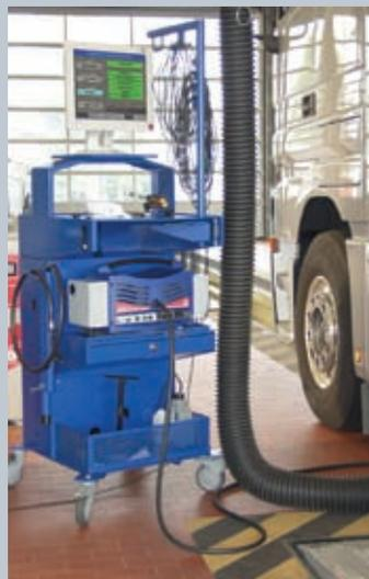
Измерение дымности грузового автомобиля
