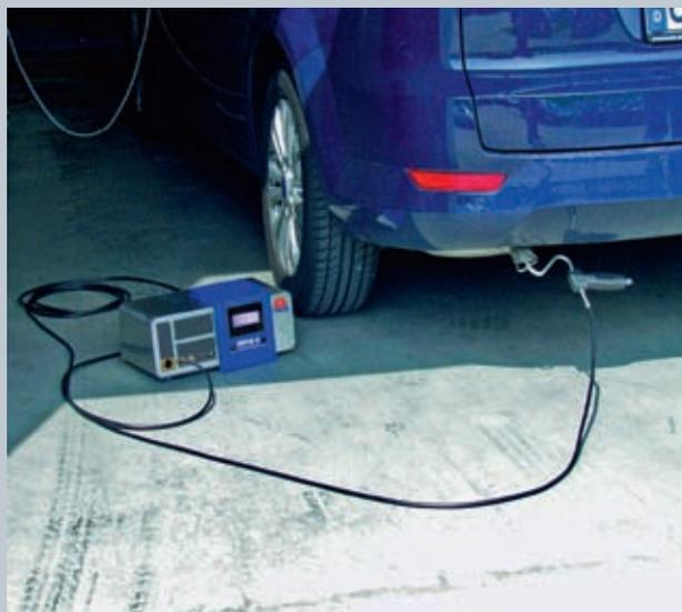
MPM 4, измерение концентрации частиц.
