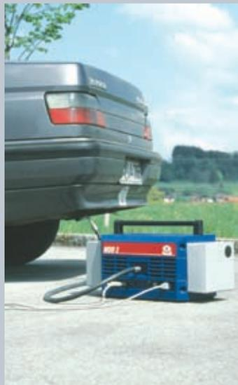
Дымомер MDO 2 Export по существу состоит из 2 компонентов: опациметра (измерительной камеры) и ручного терминала со встроенным принтером для цифрового и графического отображения измеренных величин. Опациметр располагают рядом с выхлопной трубой, ручной терминал удобно забирать с собой в кабину АТС.
