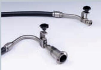
Различные газопримемные зонды для легковых и грузовых автомобилей
