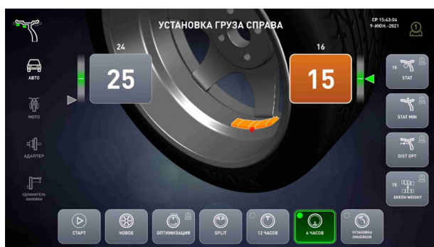
а – установить ленточный груз 15 г справа
