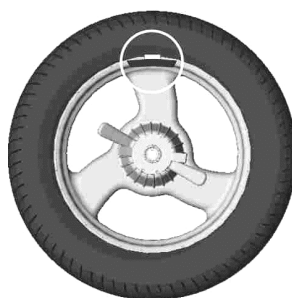
Рисунок 6.5 – Груз установлен в «12 часов»
