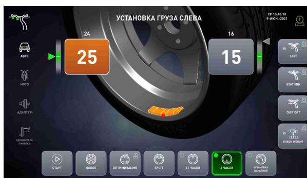
б – установить ленточный груз 25 г слева
