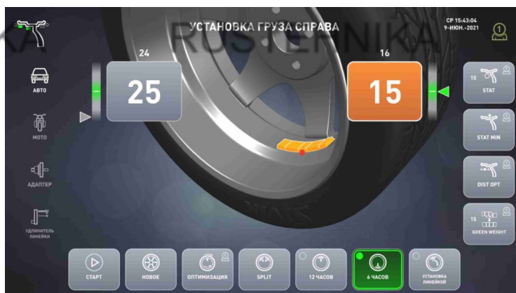
б – установка груза в «6 час»
