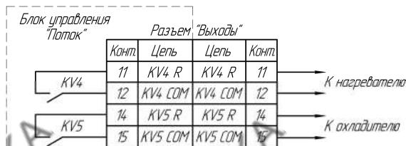
Рисунок 3.41 – Распайка разъема "Выходы".
