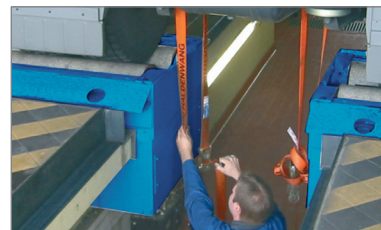
Симуляторы нагрузки MLS 2100/2200 Двухнаправленный гидроцилиндр для фиксированного или мобильного (с помощью рельс) монтажа.
