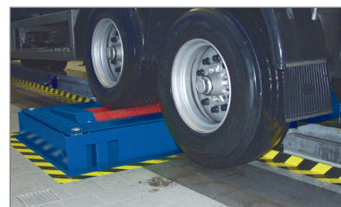
Подъемный роликовый агрегат Гидравлический подъемный роликовый агрегат для смещения осевой нагрузки тестируемой оси автомобиля.
