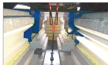
Анкерная пластина Для удержания рамы или оси автомобиля при подъеме роликового агрегата.
