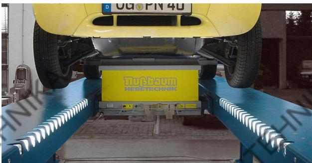
COMBI LIFT 4.45 H с траверсой LASER JACK и комплектом освещения
