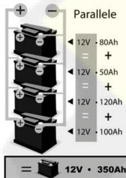
您可以采用并联方式同时对多个电池充电。（+端子与红色的夹子连接；-
