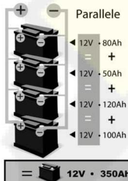
Вы можете заряжать одновременно несколько аккумуляторов при параллельном подключении (клеммы «+» подключены к красному зажиму и клеммы «-» подключены к черному зажиму). Эти аккумуляторы или группа аккумуляторов должны иметь одинаковое напряжение в 12В или 24В.
