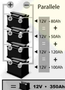
Vous pouvez charger plusieurs batteries simultanément en les connectant en parallèle (les bornes + reliées à la pince rouge et les bornes – reliées à la pince noire). Ces batteries ou groupements de batteries doivent être de même tension 12V ou 24V.
