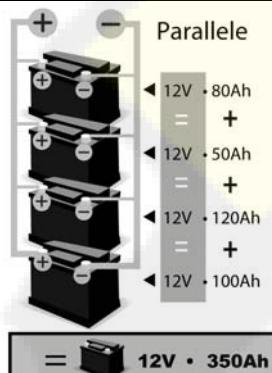
Puede cargar varias baterías conectándolas en paralelo (los bornes + con la pinza roja y los bornes – con la pinza negra). Estas baterías o agrupación de baterías deben ser de misma tensión 12V o 24V. La carga en serie no es recomendada.
