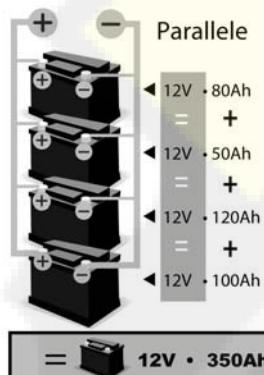
In Parallelschaltung können mehrere Batterien gleichzeitig geladen werden. Schließen Sie die rote Zange am Plus- und die schwarze Zange am Minuspol an. Hinweis: Die Batterien in der Parallelschaltung müssen alle die gleiche Spannung haben.
