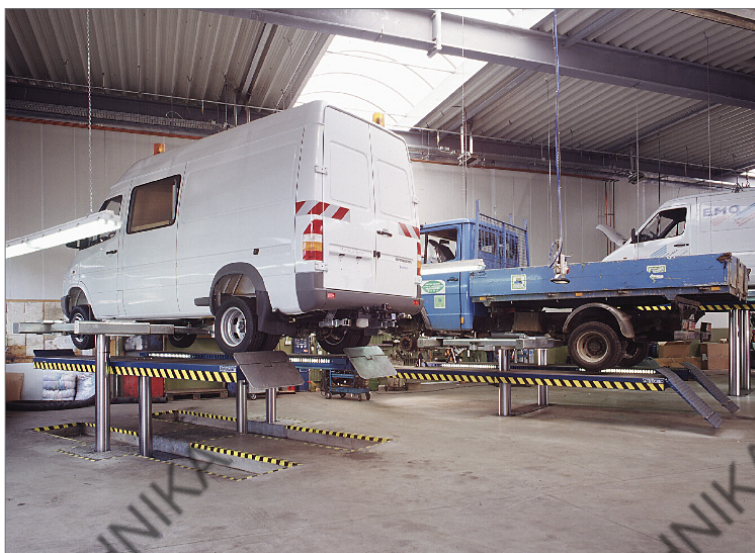
„2 в 1“ 2.50 ТТАР Н с длинными платформами и подъемными лапами
