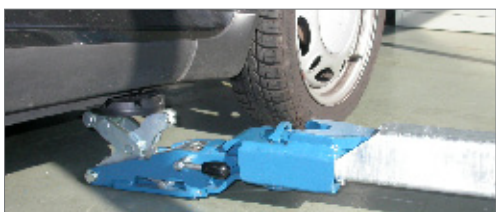
MINI-MAX адаптер для подъема автомобилей с низким клиренсом или высокими точками подхвата
