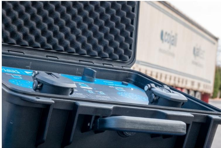
Используя Jaltest PTE в качестве источника питания для буксируемого транспортного средства, Вы сможете подключиться диагностическим прибором Jaltest к электронным системам управления, без необходимости подключения к тягачу.
