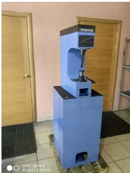
Пневмогидравлический станок КС5200 предназначен для наклейки новых и удаления старых тормозных накладок на тормозные колодки. усилие до 5200 кг.
