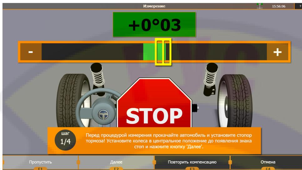
Поворачивая руль, установите передние колеса по центру, ориентируясь на зеленую зону шкалы на экране монитора. При нормальной центровке, цвет прямоугольника, на котором отображается цифра значения центровки на экране монитора меняется с красного на зеленый. На экране появится знак «Стоп». При отсутствии колебаний становится доступной кнопка «F2 - Далее». Нажмите кнопку «F2 - Далее»
