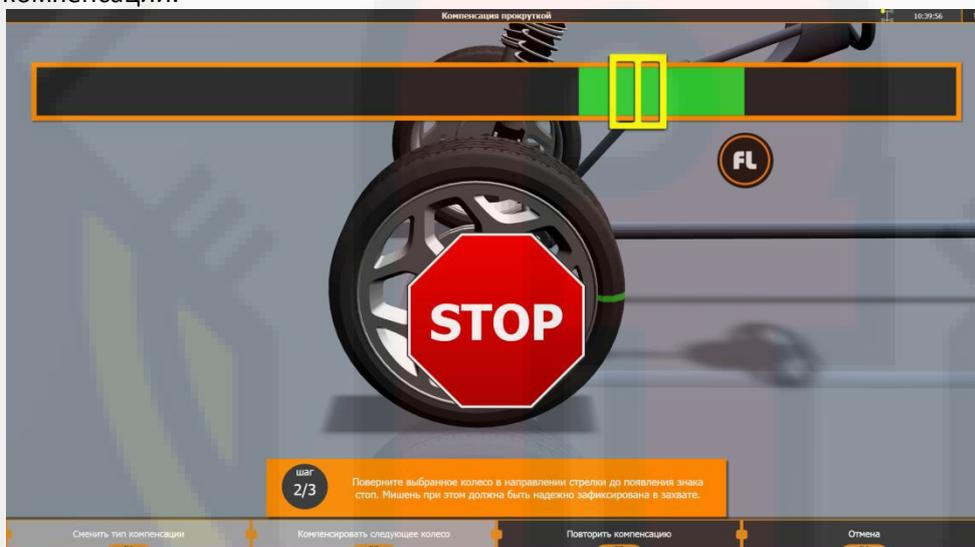
2.3.5.1.7. Затем поверните колесо обратно, как указано на экране монитора. При достижении требуемого угла поворота появится знак «Стоп». Остановите вращение и дождитесь окончания процедуры снятия данных компенсации.
