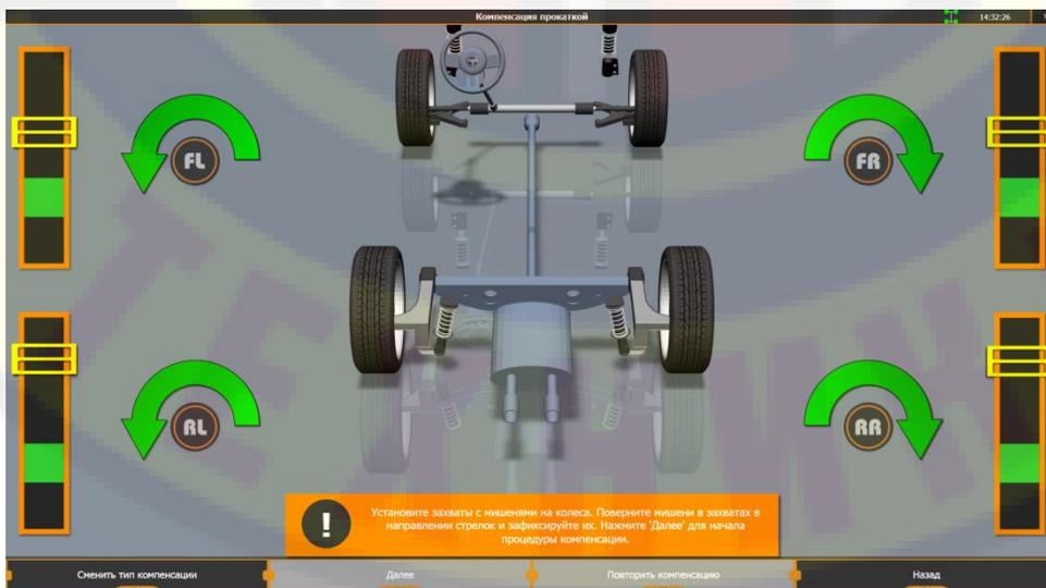
2.3.5.2.3. Для компенсации автомобиля прокатыванием нажмите кнопку «Далее».
