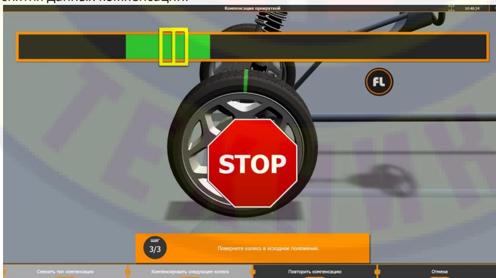
2.3.5.1.8. Убедитесь, что на экране монитора отобразилось состояние завершенной компенсации данного колеса.
