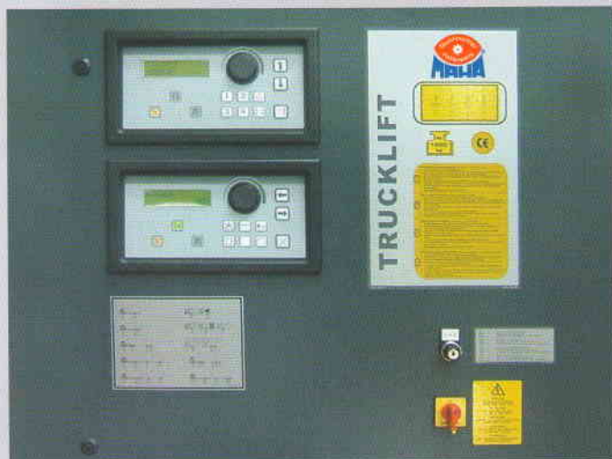
Центральный пульт управления и программирования с двумя дисплеями
