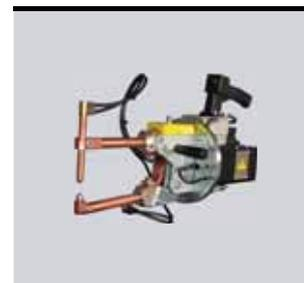
+ Подвесные клещи для контактной точечной сварки **38**
