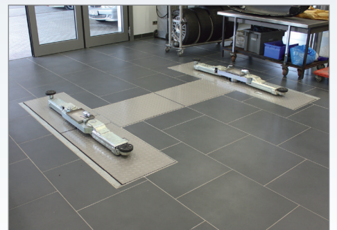
Когда крышки закрыты, а подъемник на поверхности пола, он может быть использован по назначению
