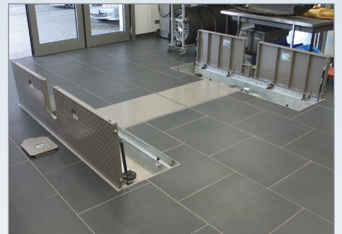
Система с пневмоамортизаторами обеспечивает легкое открывание и закрывание крышек.
