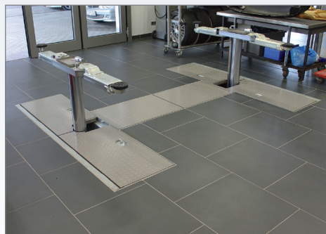
Рамная система с закрывающимися пластинами полностью гальванизирована
