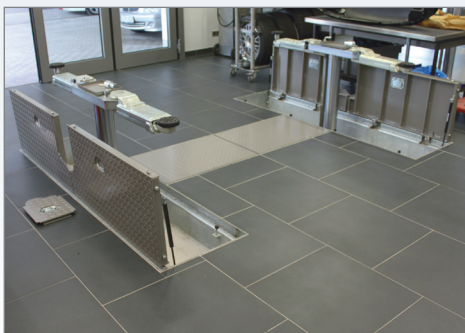
Рамная система с закрывающимися пластинами полностью гальванизирована
