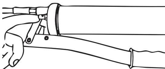
Удалите воздух из области со смазкой через комбинированный переходник для заполнения/сброса воздуха на головке шприца, или ослаблением соединения между головкой и корпусом шприца (макс. ½ оборота) или посредством многократного нажатия на рычаг.
