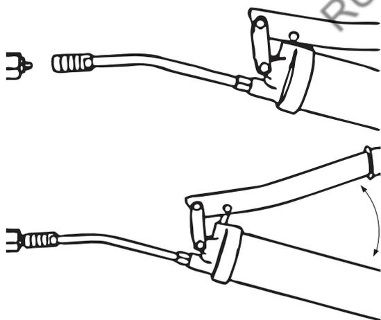
Подсоедините смазочный шприц при помощи смазочной насадки на пресс-масленку.
