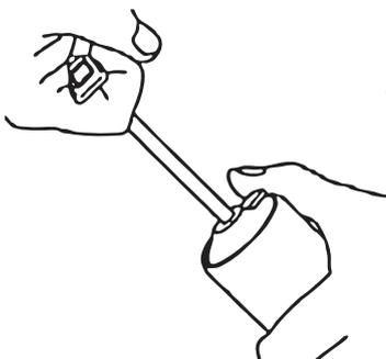
Потянув за штангу, задействуйте фиксатор, после чего снова задвиньте штангу в корпус шприца.
