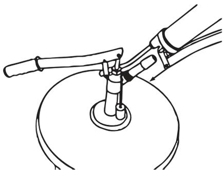
Смазочный шприц приставить переходником для заполнения на вентиль прибора для заполнения смазочных шприцов и придерживать шприц, слегка надавливая на него.
