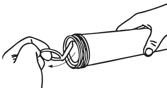
Только после этого откройте тубу, сняв крышку типа „Pull-off“ и накрутите головку шприца.
