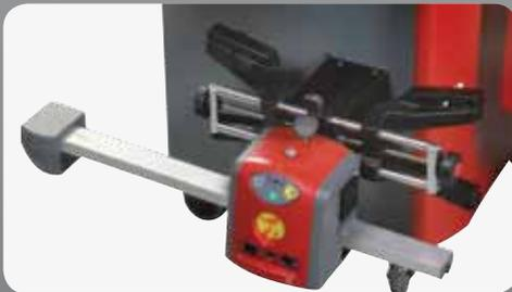
6 SUPPORTI STAFFE/RILEVATORI professionali, rimovibili per fissaggio a parete o su ponte sollevatore. 6 PROFESSIONAL CLAMP/SENSOR HEAD supports, removable for mounting on a wall or lift.
