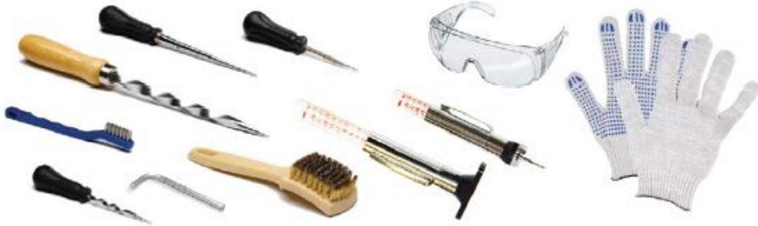
2. Нарезать протектор можно только на грузовых шинах, если на боковине присутствует маркировка REGROOVABLE. Проверьте, чтобы шина подходила для нарезки протектора. Для этого измерьте глубину протектора в нескольких местах по протектору шины и используйте наименьшие данные для того, чтобы правильно определить минимальный уровень остаточной глубины протектора. Минимальная остаточная глубина протектора должна составлять не менее 2–3 мм.
