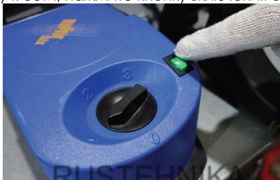
10. Установите необходимую мощность с помощью переключателя трансформатора.
